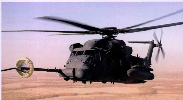
▶ MH-53J“低空铺路”,主旋翼直径22.02米,机长26.90,机宽2.69米,机高7.60米,最大时速315千米。它加装了许多特种作战使用的设备。例如机头圆形的突起部分,是一部地形追踪雷达,机身的右侧下方有一具前视红外装置,同侧还有一个空中受油探管,机头内加装了惯性导航装置,机身两侧的副油箱挂架上方,各装一具红外干扰装置。一般直升机的起落架都是固定的,而“低空铺路”的起落架却可以收放
