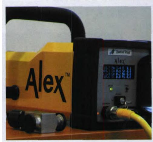
放射源释放的能量。多道分析仪使用软件读取能量输出模式，将其与一个图形匹配，显示结果。便携式分析仪可以专门探测放射性同位素中的  $\gamma$  辐射和中子的存在，从而增强对钚的探测。钚是在反应堆中通过辐照铀-238制造的。和一般的辐射探测器不同，该装置可用于寻找和定位未知辐射源，测定相对剂量率和从同位素方面鉴别源。结果显示在数字屏幕上。例如铀和钚的同位素能很好地显示出核燃料是否已经被后处理。另一个类型，手提式  $\gamma$  能谱仪，可以专门测量铀和它是否已经被浓缩。在实验室、设施或其他的工业环境中，它都能完成准确和迅速的铀核查测量。某些同位素的比率可以给出重要信息——例如使用过的浓缩技术类型。
