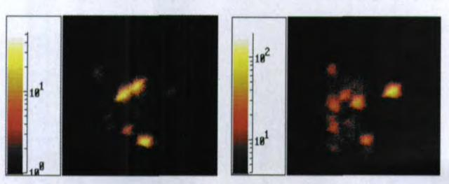
IAEA 分析人员利用次级离子质谱测定法获得的铀-235 和铀-238 离子图像。图像展示的是来自直径为 150 微米面积的离子。每个亮点是一个颗粒，通过利用数学方法比较这两个图像，可以容易地计算出探测到的所有颗粒的浓缩度。（来源：IAEA）
