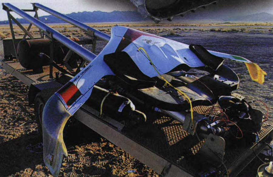
美国著名军工企业——诺斯罗普·格鲁曼公司研制的“杀人蜂”无人机。它具有自主、远程飞行的潜力，可低空飞行，能提供实时视频
